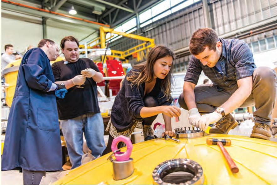
Chercheurs assemblant le spectromètre de masse EMMA à TRIUMF.
